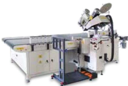
El Nexus 3500 está diseñado para alcanzar la máxima productividad con una operación ergonómica y altamente eficiente en el cierre de bordes. Su cinta transportadora motorizada, el sistema de volteo de colchones, el ajuste automático del cabezal de costura, la reducción de velocidad en las esquinas y los ajustes fáciles de altura y velocidad aseguran la mejor experiencia en el proceso de cierre de bordes para cualquier tipo de colchón.
